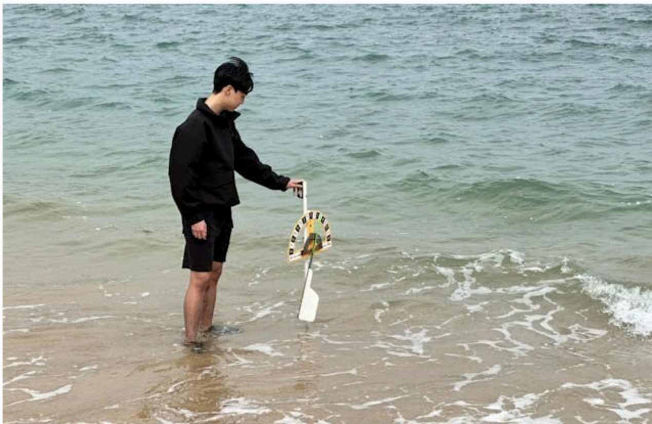
校內教師團隊親自製作的教材——沖流回流指示器，能具象地展示海浪衝擊海岸時「沖流」與「回流」的能量消長過程。（郊野學園提供）
